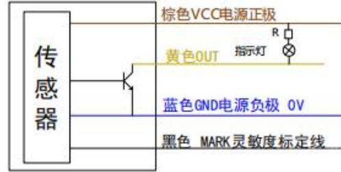
NPN信号输出：连接LED指示灯的接线方法
