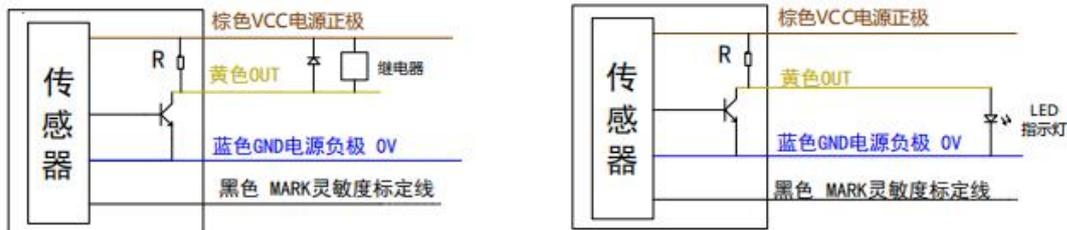
高低电平信号输出：连接继电器的接线方法
