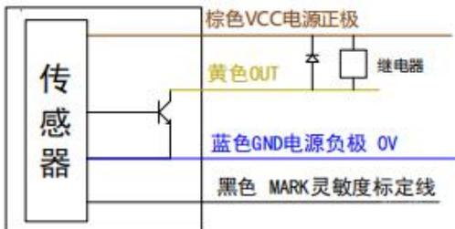
NPN信号输出：连接继电器的接线方法
